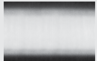
Pintura de látex a través de una boquilla HEA 517 a 1,000 psi
